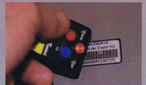
Die Lesegeräte übertragen die Daten via Bluetooth-Schnittstelle an die mobilen Endgeräte. Nutzer authentifizieren sich über einen RFID-Tag, der sich auf ihrem Ausweis befindet.
