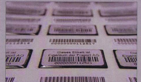
Der von Fraport eingesetzte RFID-Transponder verfügt über eine Speicherkapazität von einem Kilobyte. Gespeicherte Daten umfassen mitunter Equipmentnummer sowie das Wartungsdatum.
